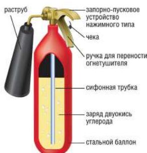
Устройство с зарядом двуокиси углерода ( $\text{CO}_2$ ) сжиженной, это позволяет снижать температуру и вытеснять кислород в месте возгорания.
